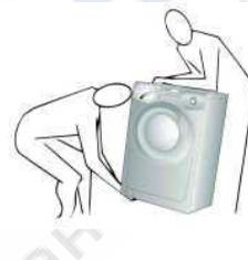
l. При перемещении машины не поднимайте ее за ручки управления или за дозатор для моющих средств. При перевозке люк не должен опираться на тележку;
